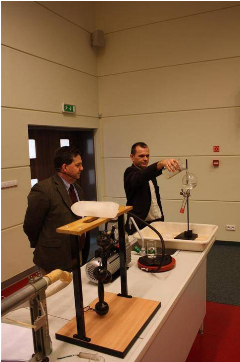
Doświadczenie z „gotowaniem przez schładzanie”. Na pierwszym planie bryła lodu z hantlami
